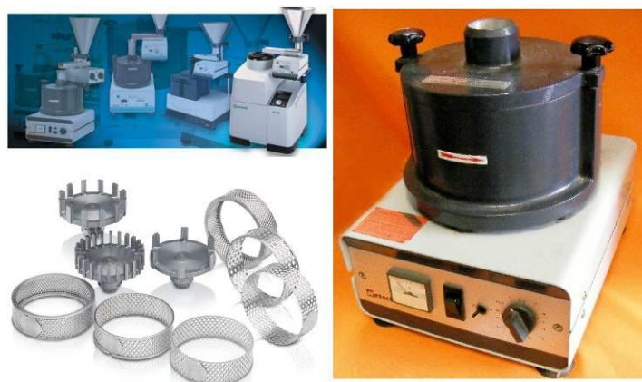
Slika 1. Izgleda mehaničkog aktivatora ZM 1 i seta promenljivih sita.
