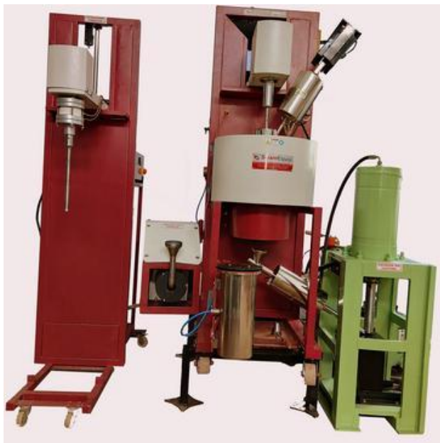
Уређај за вртложно ливење са ливењем кроз отвор на дну уређаја
